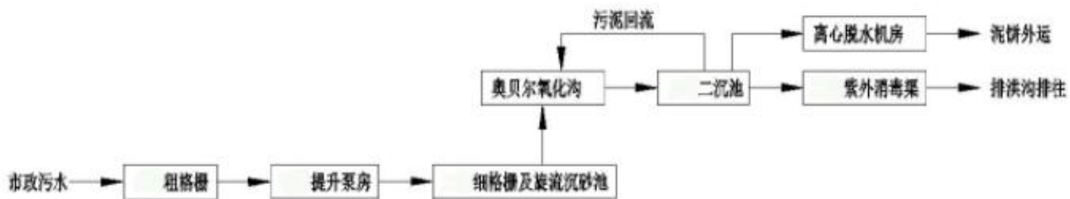
图 4-1 北区水质净化厂污水处理工艺流程图
