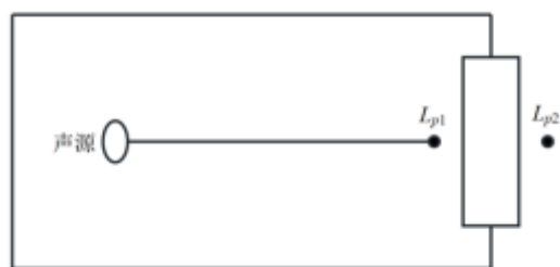
图 4-2 室内声源等效为室外声源图例
