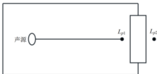
图 4-2 室内声源等效为室外声源图例
